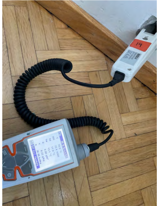
Rakenneavaus 3 eristetilan olosuhteet 72,4 %
