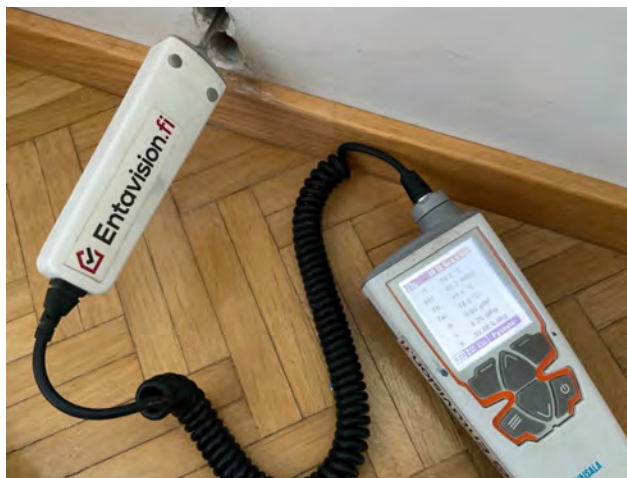
EPS-eristeen kosteus 62%. Noin 180mm betonia sisäkuoressa
