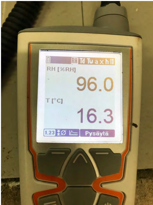
Alapohjan hiekkatilan kosteus
